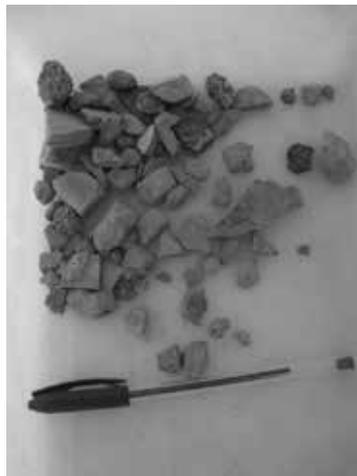
Figura 3 – Impurezas retiradas do lote de RCC apresentado na Figura 2.
