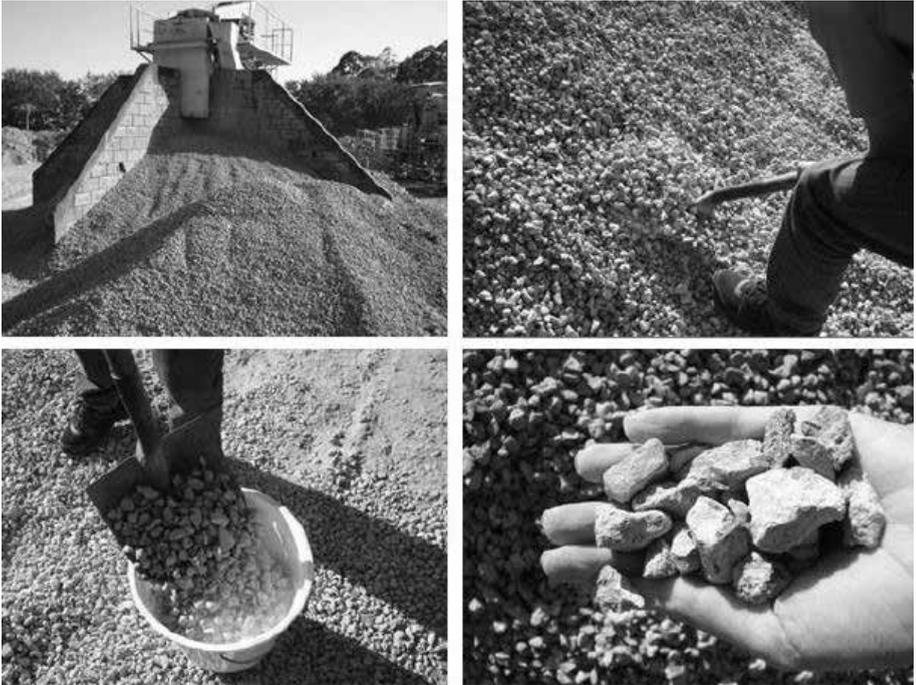
Figura 1 – RCC retirado da Usina de Reciclagem de São Carlos.
